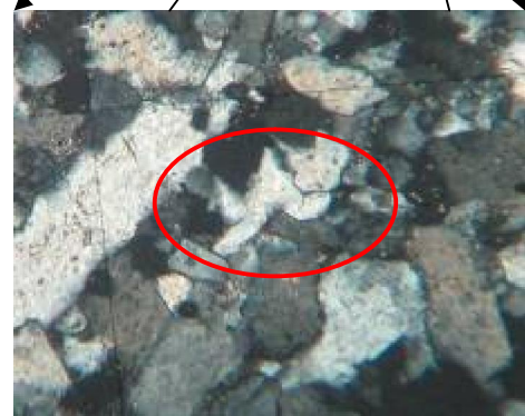
تصویر شماره ۴: سلسستین (بدون کانه زایی) و در نور های پلاریزه و عادی که در برخی نقاط حالت خمیری از خود نشان می دهد.
