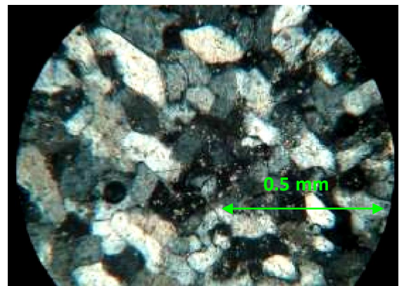
تصویر شماره ۴: سلسستین (بدون کانه زایی) و در نور های پلاریزه و عادی که در برخی نقاط حالت خمیری از خود نشان می دهد.
